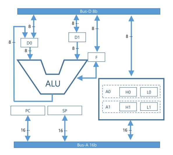
La unidad de control tiene dos registros de datos (D0 y D1), dos de direcciones (A0 y A1), un contador de programa (PC), un puntero de pila (SP) y un registro de flags (F) que registra los resultados de las operaciones en la ALU.
